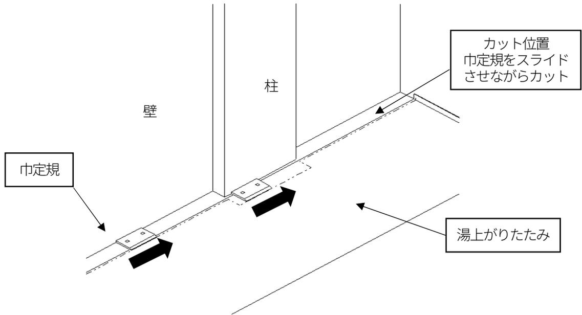
凹凸が大きい箇所は型紙で型合わせをしてください。その後、カッターでカットしてください。
