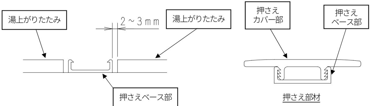
③2枚目以降の湯上がりたたみを仮置きし、同様に押さえ部材を設置してください。最後の湯上がりたたみについては1枚目と同様にして壁際部分を巾定規で正確に線出しをしてカットしてください。
