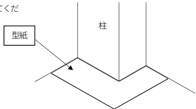
②押さえ部材のベース部を設置し、ビス、両面テープ等で固定してください。また、下図のように2~3mm隙間を設けてください。(押さえは市販の5mm厚用を用意してください。)
